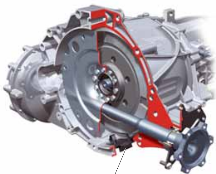
Serviceöffnung mit Abdeckung
